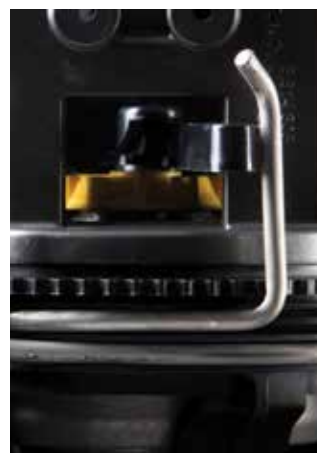
РЕГУЛИРУЕМЫЕ ОГРАНИЧИТЕЛИ ДЛЯ ДОСТИЖЕНИЯ НАИЛУЧШЕЙ ТРАЕКТОРИИ ПОКРЫТИЯ.
